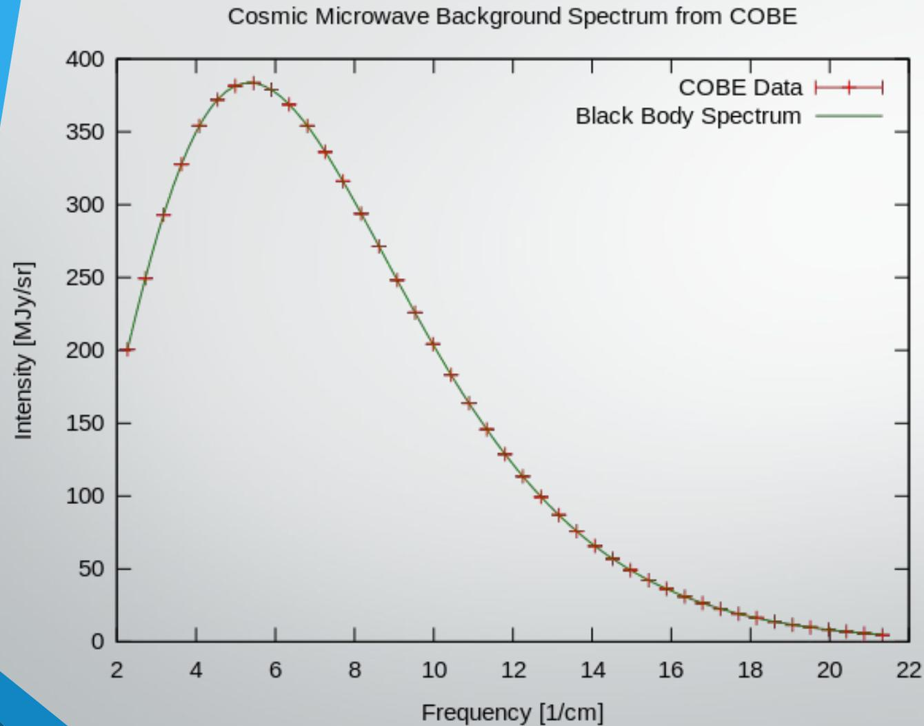
Спектр реликтового излучения по данным, полученным с помощью инструмента FIRAS на борту спутника COBE
