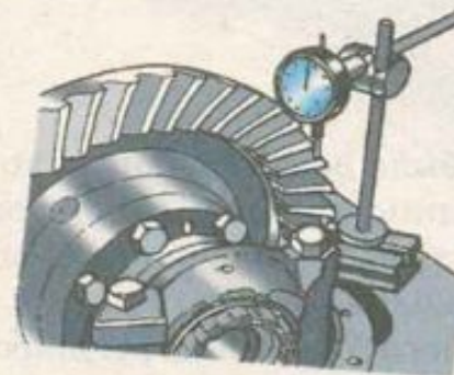
Рис. 5.34. Проверка бокового зазора в зацеплении зубьев шестерен главной передачи (мост с балкой типа банджо)
