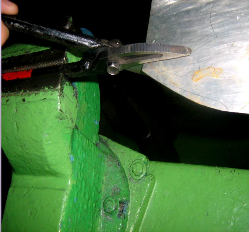
Резание слесарными ножницами
