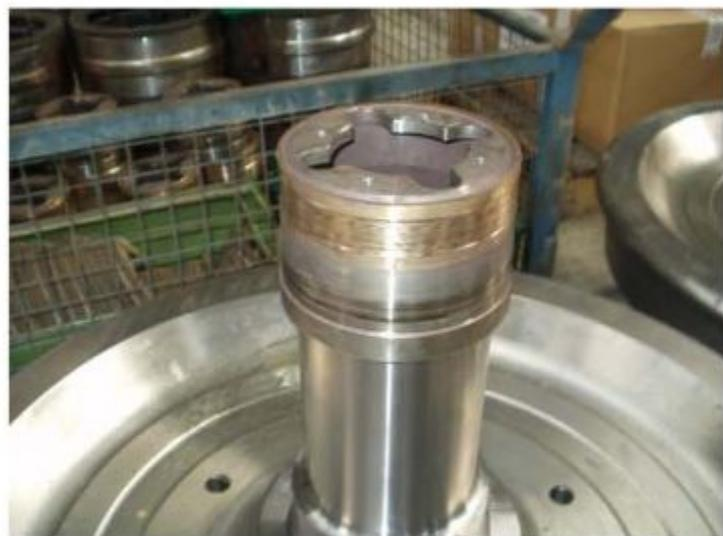
Крышка установленная над подшипником, обеспечивающая контакт для шунтирования
