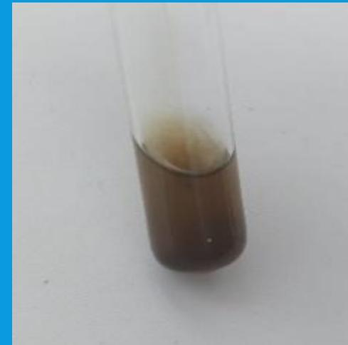
**Реакция с  $\text{KMnO}_4$ .** В табачном дыме содержатся восстановители, обладающие высокой токсичностью и раздражающим действием, например бензальдегид, формальдегид, акролеин. Их мы обнаруживали следующим образом: в две пробирки наливали по 1 мл раствора табачного дыма и раствора, полученного при вымачивании сигаретного фильтра. Добавляли в пробирки несколько капель 5%-ного раствора  $\text{KMnO}_4$ .
