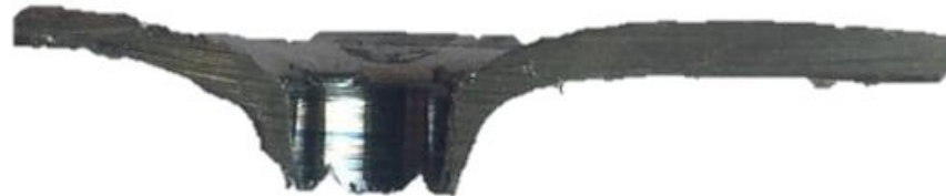
Рис. 1 - Деформированная заготовка в разрезе по оси отверстия
