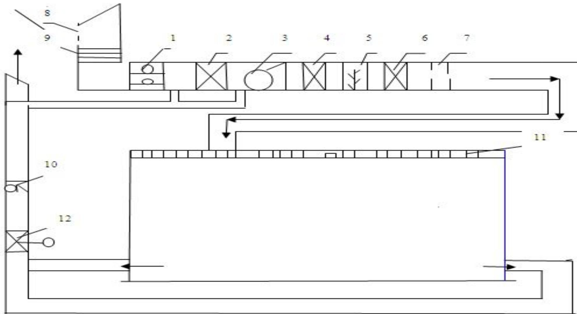
Схема кондиционера: 1 – фильтр грубой очистки 2 – калорифер парового подогрева, 3 – приточный вентилятор, 4 – поверхностный воздухоохладитель, 5 – увлажнительное устройство, 6 – калорифер вторичного подогрева, 7 – воздухораспределительное устройство, 8 шахта забора, 9– жалюзийная решетка, 10 – вытяжной вентилятор, 11 – фильтры тонкой очистки, 12 – воздухозаборное устройство.
