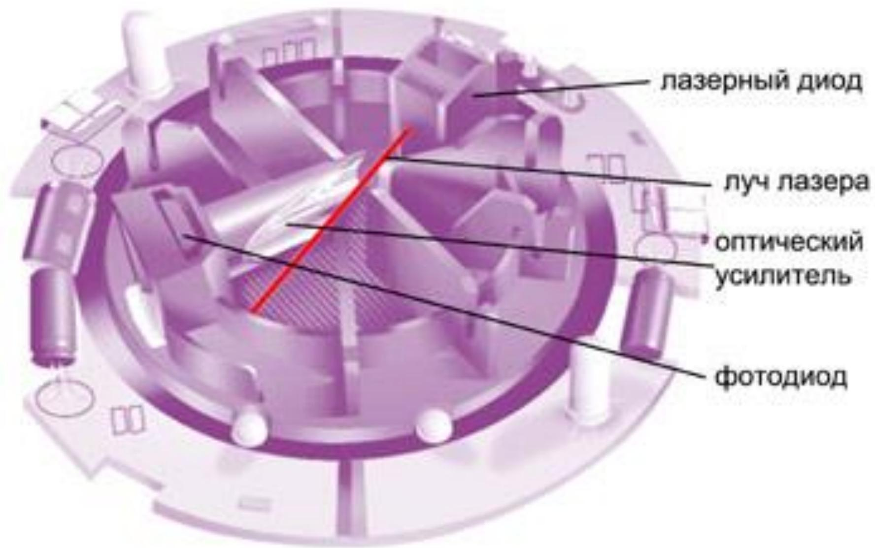
В лазерном дымовом извещателе светодиод заменен миниатюрным лазером, фокусировка луча которого обеспечивает одновременно повышение яркости излучения на два порядка (в 100 раз) Вдоль луча лазера размещается оптический усилитель, который принимает сигнал со всей протяженности луча лазера и передает его на фотодиод. Сигнал о возможности возникновения пожара подается на графический дисплей, размещаемый на пульте управления производственным участком.
