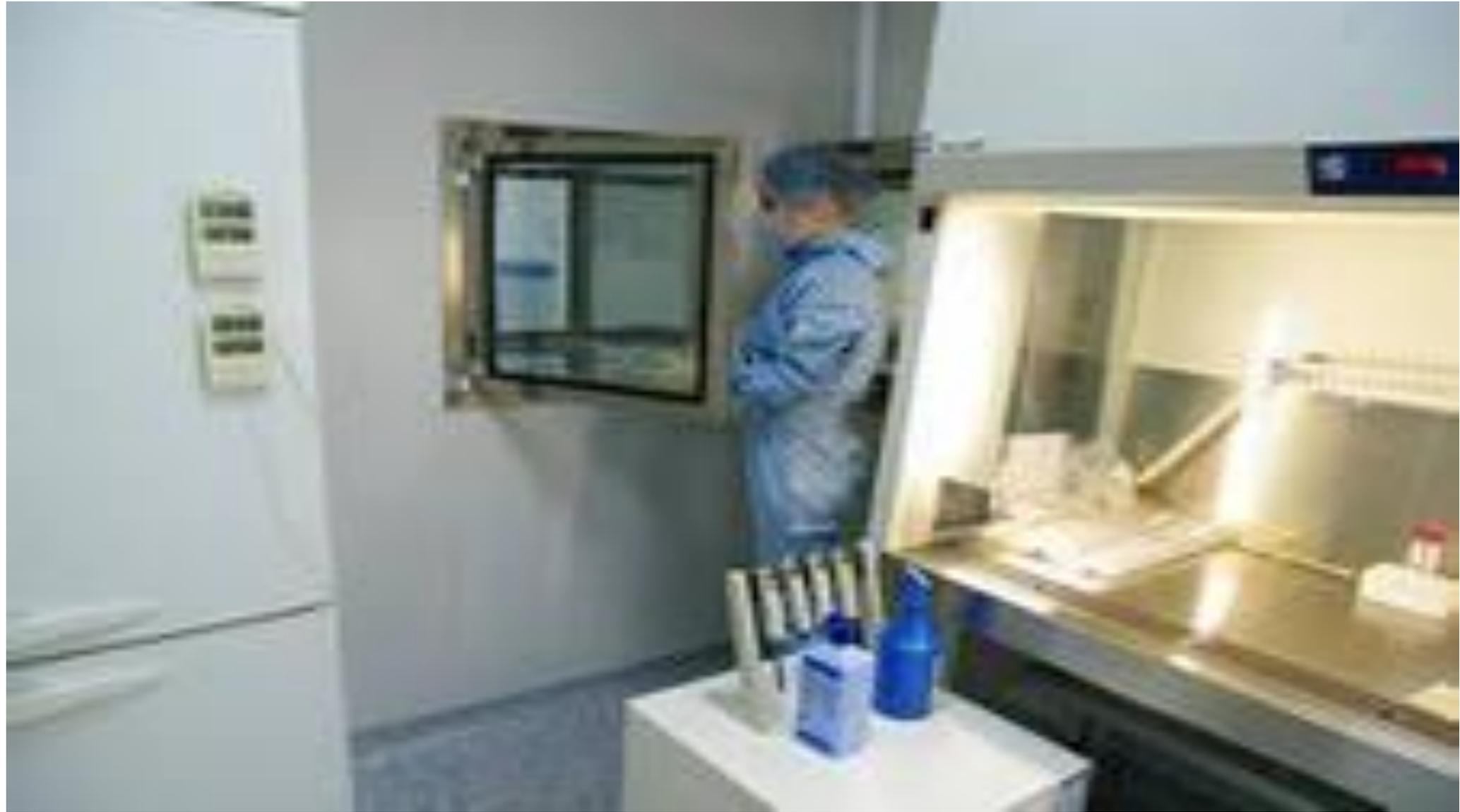
Для «чистого» помещения рабочей зоной считают зону проведения технологической операции, а зона дыхания – это пространство на высоте 1,5 метра для рабочего места.
