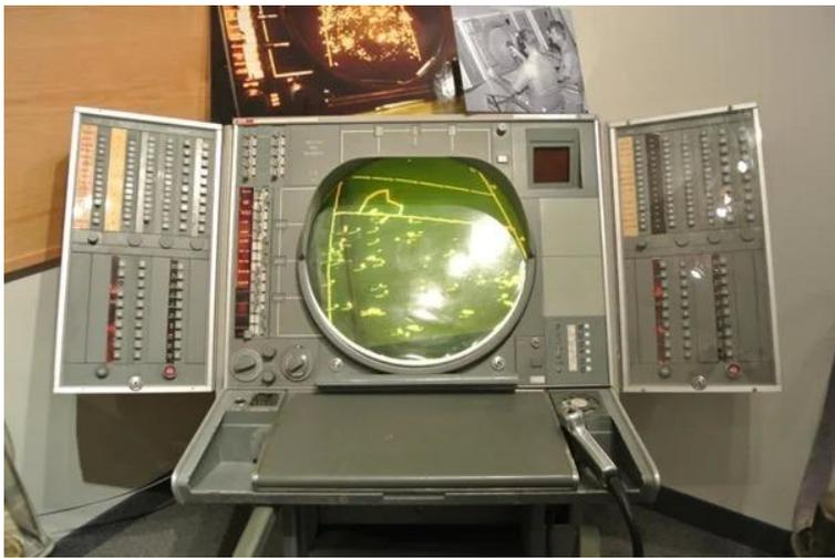
Каждый ЭВМ мог выполнять 75 000 инструкций в секунду и выводил радиолокационные данные на 150 консолей операторов, которые выбирали объекты и получали информацию с помощью светового пера (или Light gun - светового пистолета).
