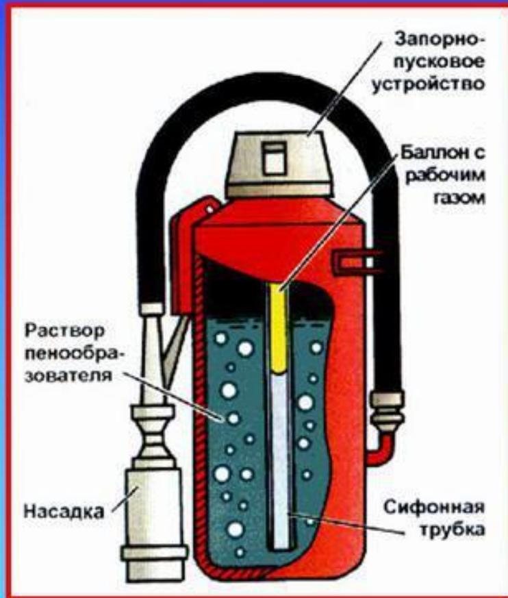
предназначены для тушения пожаров и загораний твердых веществ и материалов, ЛВЖ и ГЖ, кроме щелочных металлов и веществ, горение которых происходит без доступа воздуха, а также электроустановок под напряжением
