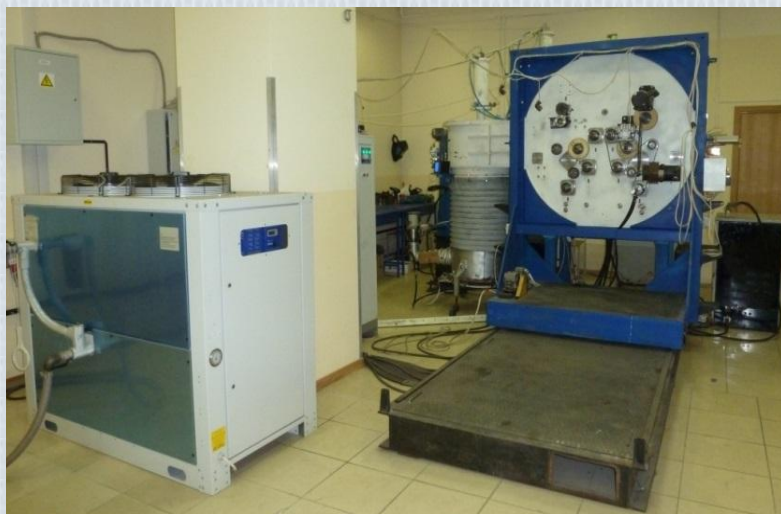
Установка вакуумной металлизации бусофита
