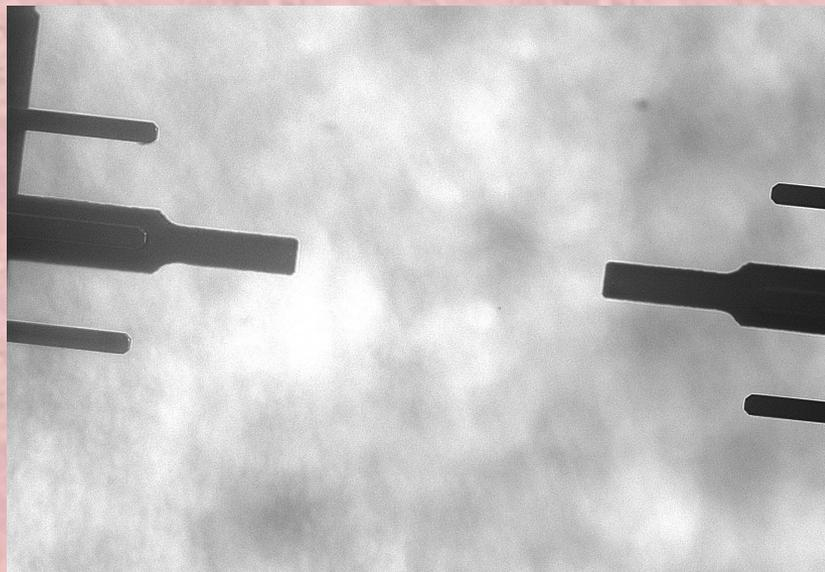
**Рисунок 11.** Пара электродов в световом микроскопе (справа в увеличенном масштабе)
