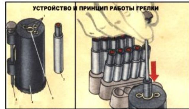
1. Бюквенные гнезда; 2. Патрон грелки; 3. Центральное гнездо; 4. Корпус грелки; 5. Штырь.
