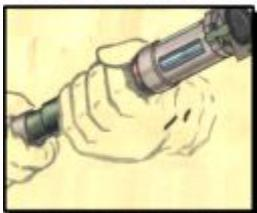
ОВ в пробах почвы и сыпучих материалов определяется с использованием защитного колпачка и противодымного фильтра.
