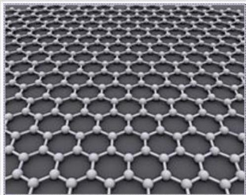
Рис. 1. Идеальная кристаллическая структура графена представляет собой гексагональную кристаллическую решётку.
