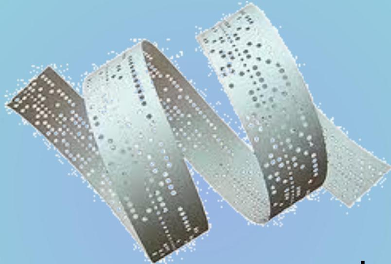
**Перфоленты** — носитель информации в виде узкой тонкой ленты из бумаги или пластмассы, на которую информация записывается пробивкой отверстий (перфораций).
