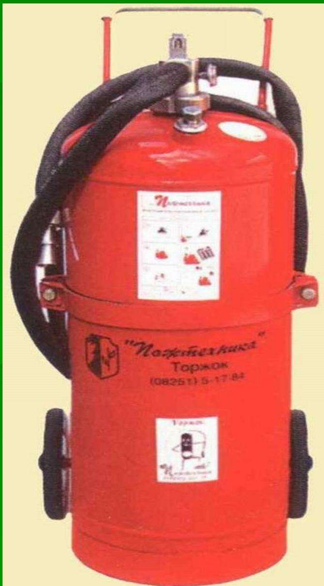
Принцип работы передвижного огнетушителя ОП-50(З) основан на вытеснении огнетушащего порошка (при открытом клапане запорного устройства) сжатым воздухом, находящимся в емкости.
