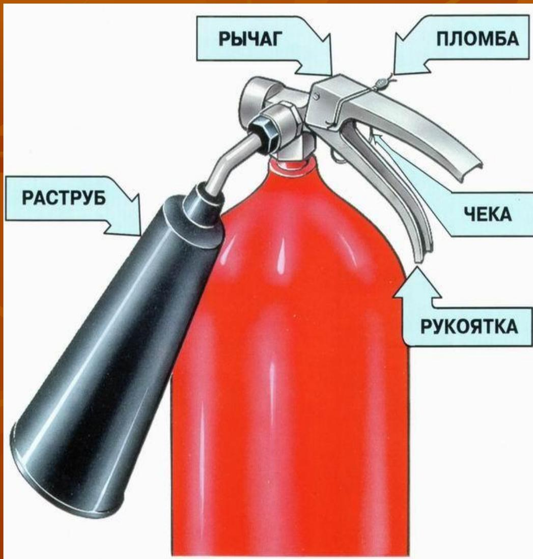
Углекислотные огнетушители предназначены для тушения загораний различных веществ и материалов, а также электроустановок, кабелей и проводов, находящихся под напряжением до 1000 В
