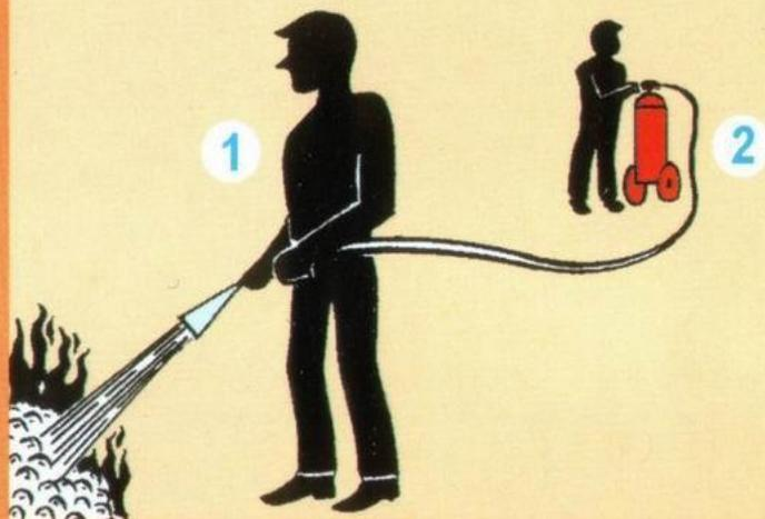
При работе углекислотных огнетушителей всех типов запрещается держать раструб незащищенной рукой, так как при выходе углекислоты образуется снеговая масса с температурой минус 80°C.
