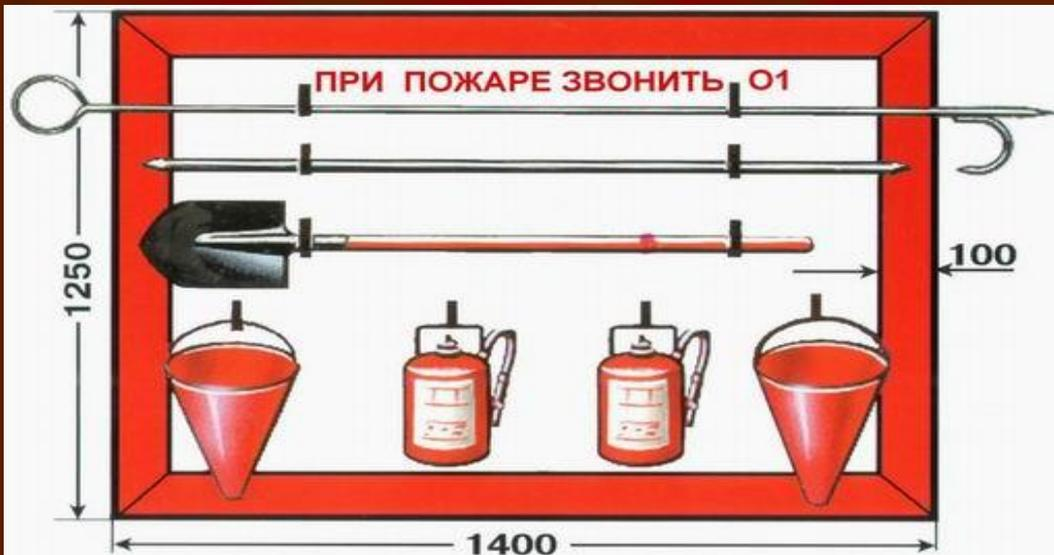
**ПРЕДНАЗНАЧЕН** для размещения первичных средств пожаротушения, немеханизированного инструмента и пожарного инвентаря в производственных и складских помещениях, не оборудованных противопожарным водопроводом и автоматическими установками пожаротушения, а также на территории предприятий, не имеющих наружного противопожарного водопровода, или при удалении зданий (сооружений), наружных технологических установок на расстояние более 100 м от наружных пожарных водосточников.
