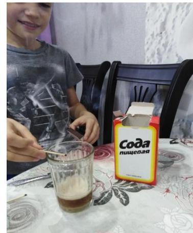
Сначала провел опыт без соды. Для этого в баночку налил уксус. Зажженную спичку опустил в баночку, наблюдал горение. Затем добавил к уксусу немного соды и снова опустил спичку в баночку. Выделяющийся в результате реакции углекислый газ погасил пламя спички
