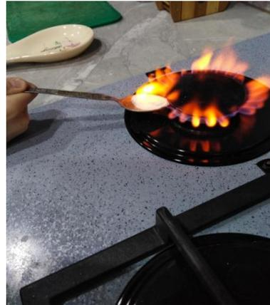
При сгорании пропан-бутановой смеси пламя горелки имеет голубой цвет. Если поднести к пламени ложку с содой, то пламя окрашивается в желтый цвет. Это объясняется наличием натрия в составе соды, именно он окрашивает пламя в желтый цвет.
