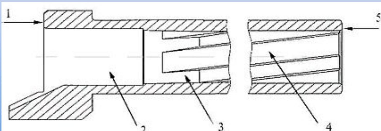
**Продольный разрез ствола нарезного стрелкового оружия: 1 - казенный срез; 2 - патронник; 3 - дульный вход; 4 - направляющая часть; 5 - дульный срез**
