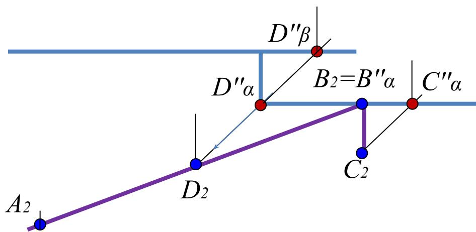
Построить тень линии  $l$  на плоской фигуре и плоскости проекций.
