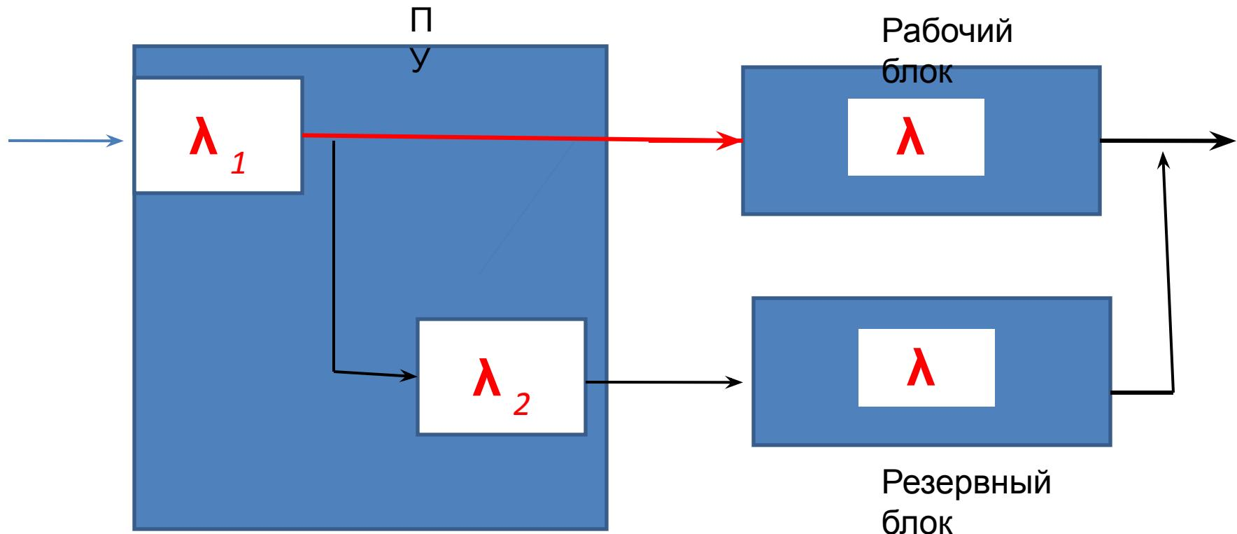
Смешанное соед. элементов: **последовательно-параллельное**.
