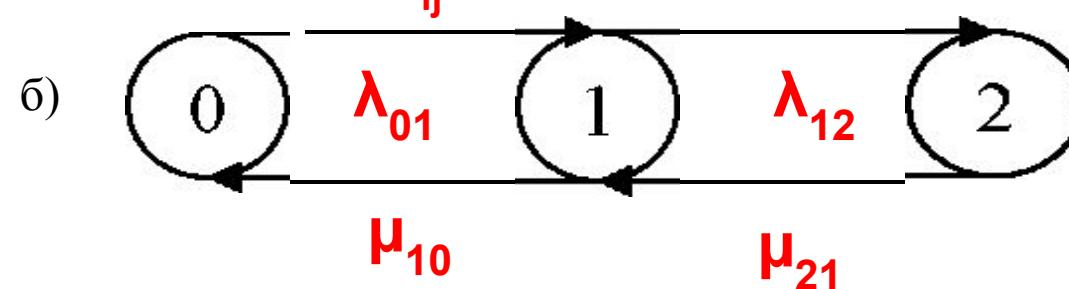
Схема резервированного объекта (а) и график его состояний (б).
