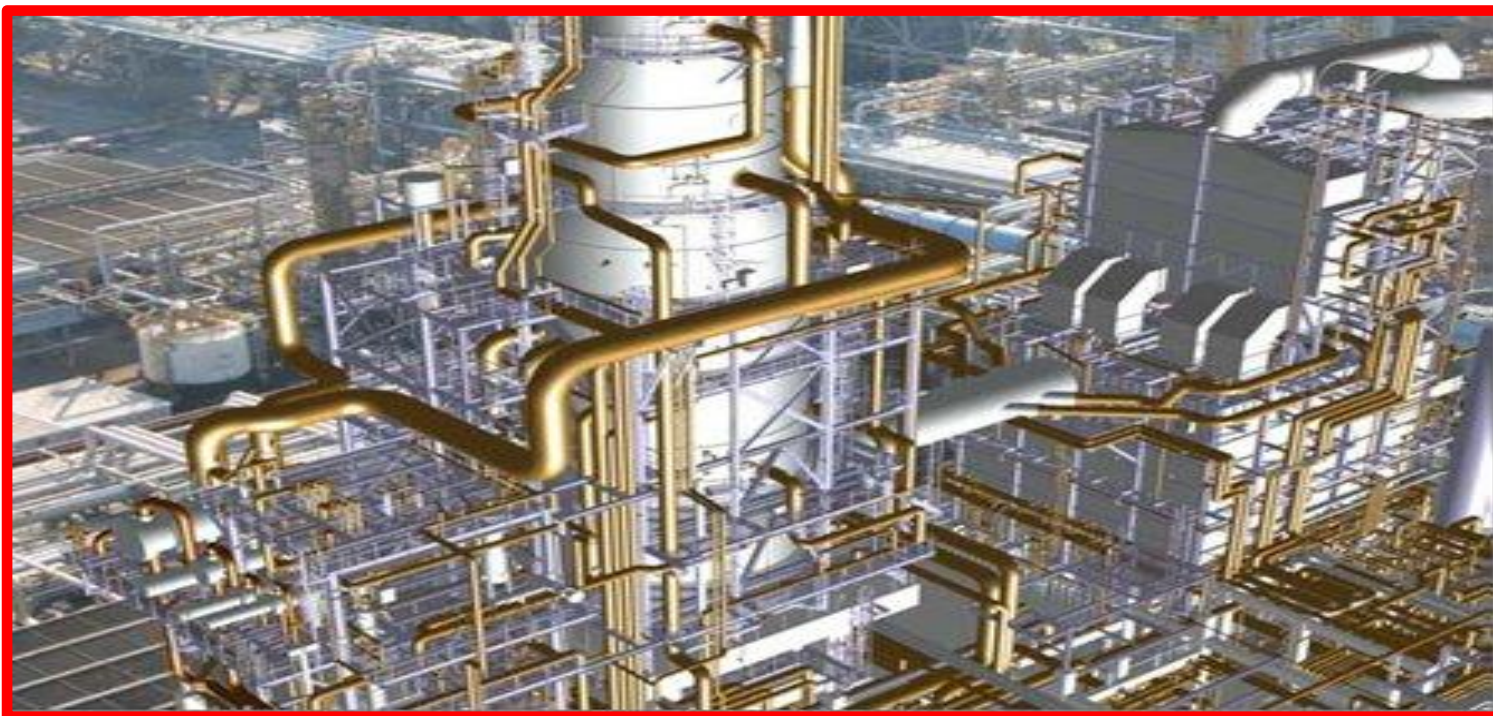
Макет установ ки ваку умной дистил ляции на НПЗ
