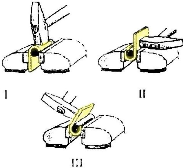
Последовательность переходов при гибке цилиндрической втулки на оправке показана на поз. I, II, и III. При гибке цилиндрической втулки необходимо соблюдать особую осторожность, т.к. сильными и неточными ударами молотка можно вызвать деформацию втулки
