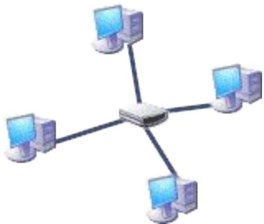
К каждой рабочей станции подходит отдельный кабель из одного узла - сервера, управляющий всей сетью, определяет маршруты передачи сообщений, подключает периферийные устройства, является хранилищем данных для всей сети.
