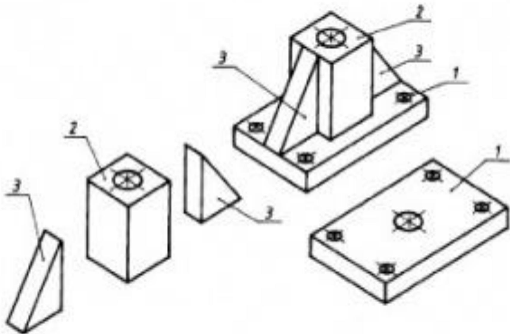
Рис. 141. Анализ геометрической формы детали
