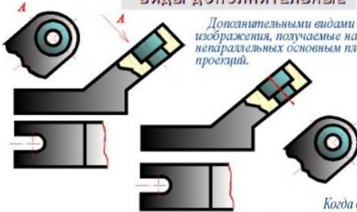
*Когда дополнительный вид расположен в непосредственной проекционной связи с соответствующим изображением, стрелку и надпись над видом не наносят.*
