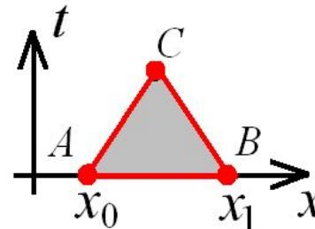
Решение в любой точке характеристического треугольника определяется только начальными данными на отрезке  $[x_0, x_1]$ . Начальные данными вне отрезка  $[x_0, x_1]$  не влияют на решение в  $\Delta ABC$ .
