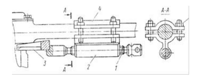
Рисунок 1 - Снятие съемником пальцев реактивных штанг: 1 -винт; 2 - корпус; 3 - клин; 4 - крышка; 5 - гайка; 6 – шпилька
