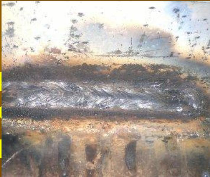
Сварной шов при правильно подобранной технологии должен быть равномерно распределенным по
