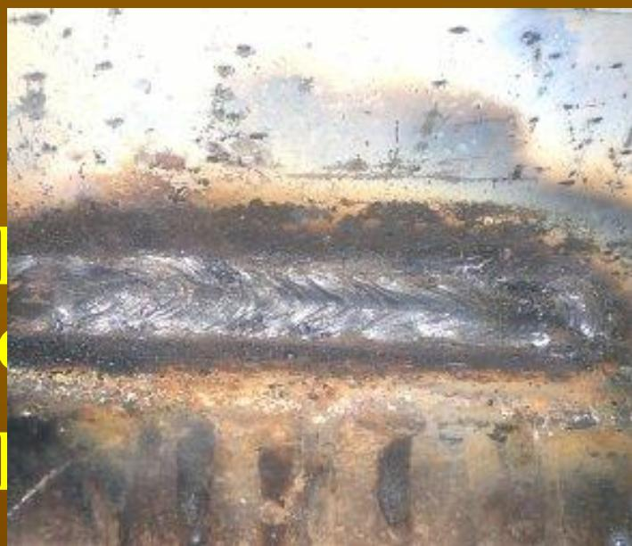
Сварной шов при правильном подборе технологии сварки имеет равномерно распределенным по поверхности основного металла .
