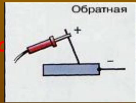
Сварка с повышенной скоростью плавления электродов.
