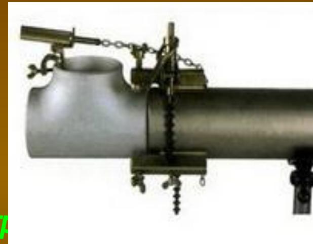
✓ Центрируют и фиксируют трубы различного диаметра. Они применяются для фиксации прямолинейных участков труб в процессе сварки.
