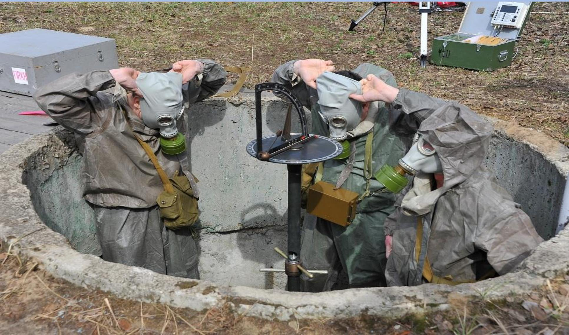
Посты РХН предназначены для: определения ориентировочных параметров ядерных взрывов наблюдением за направлением движения облака зараженного воздуха, уровнями радиации типом ОВ (АХОВ) в районе поста; метеонаблюдения; взятия проб почвы, грунта, растительности в районе поста и отправка их в лаборатории для анализа.
