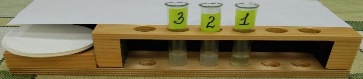
Для определения хлорид - ионов использовала реактив нитрат серебра.
