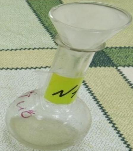
**Опыт № 3. Качественное определение хлорид-ионов.** Для этого отлила небольшие порции каждого образца в чистые пробирки.
