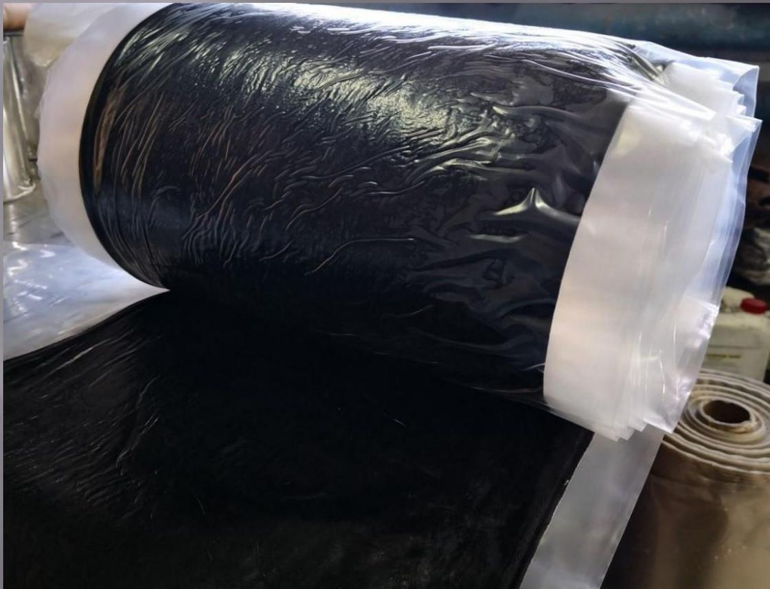
*Для получения высокоэластичных прочных изделий (покрышек, трансмиссионных лент, ремней, рукавов) резиновую смесь наносят на высокопрочные ткани (корд, белтинг) путем прессования или пропитывания. Многие резиновые изделия армируют металлическими деталями. Любой процесс формования заканчивается процессом вулканизации.*
