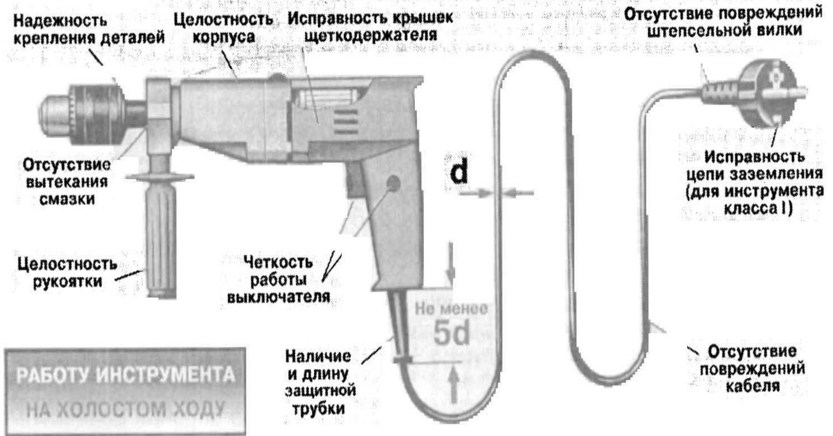
Рис. 7. Проверка ручных электрических машин перед началом работы (плакат)
