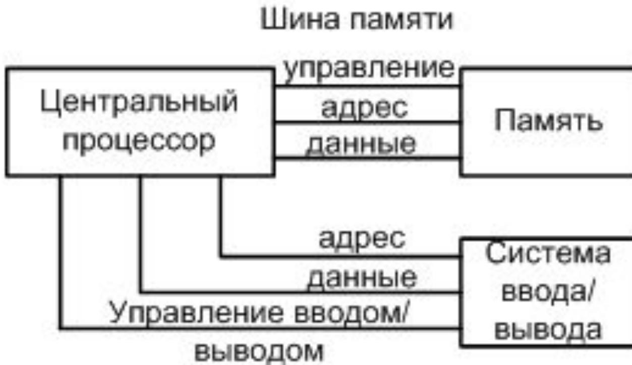
В варианте с отдельными шинами памяти и ввода/вывода обмен информацией между ЦП и памятью физически отделен от ввода/вывода, поскольку обеспечивается полностью независимыми шинами.
