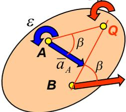
2) Соединяем точку B с МЦУ  $\vec{a}_B$  и определяем ускорение этой точки:
