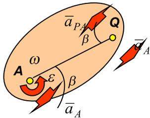
Пусть известно ускорение одной из точек фигуры, угловая скорость и угловое ускорение вокруг этой точки:
