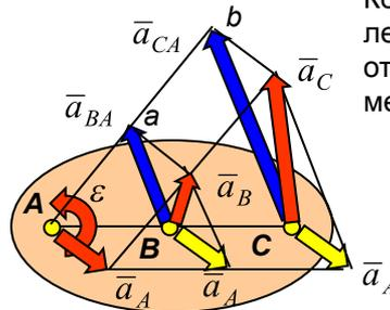
Концы векторов ускорений точек  $\vec{a}_{BA}$  и  $\vec{a}_{CA}$  лежат на одной прямой  $abc$  и делят ее на отрезки пропорциональные расстояниям между точками:
