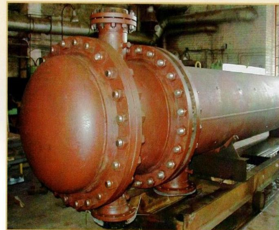
Б) трубы и кожух свободно перемещаются относительно друг друга благодаря применению U - образных трубных пучков
