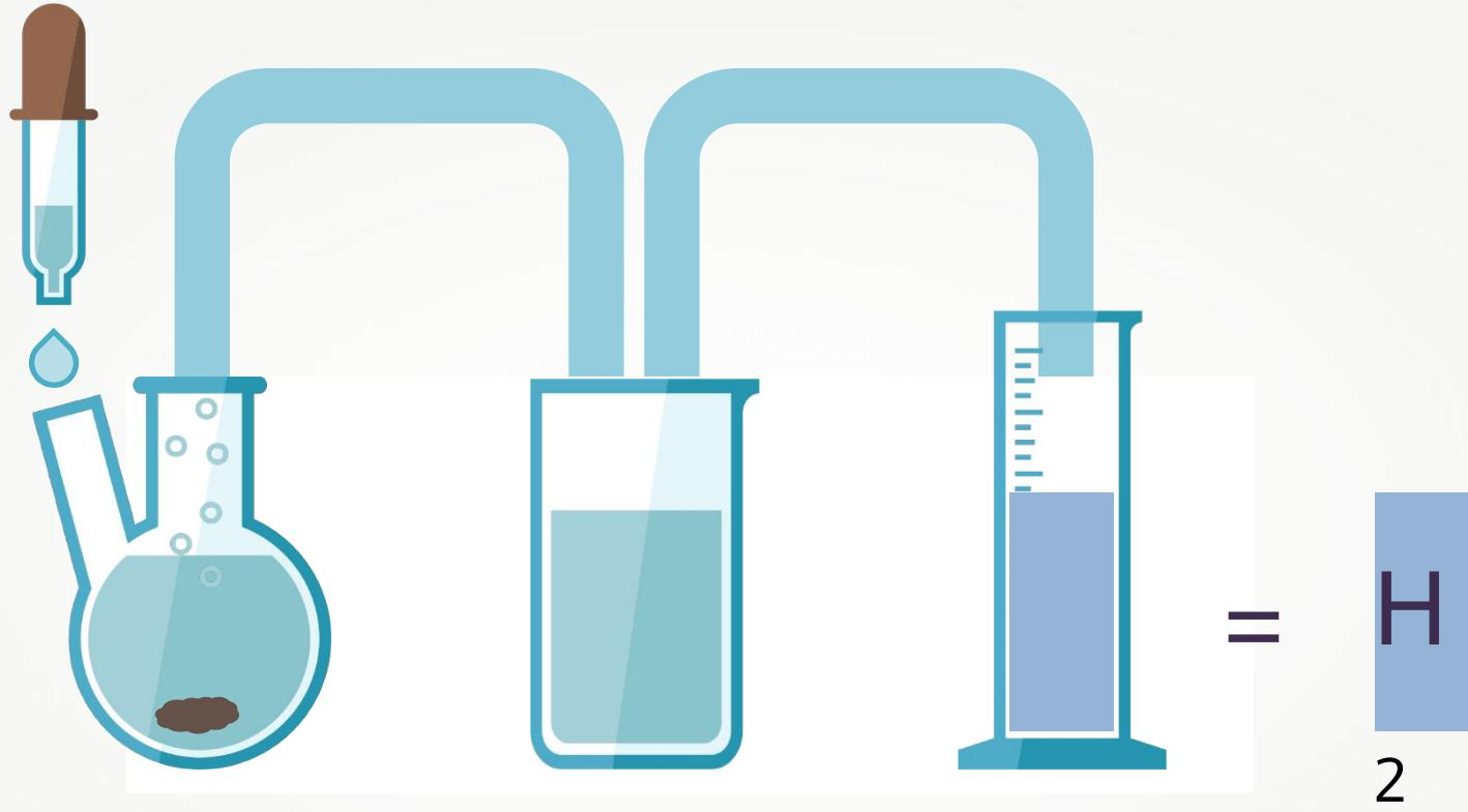
Объём вытесненной воды в цилиндре соответствует объёму выделившегося водорода.
