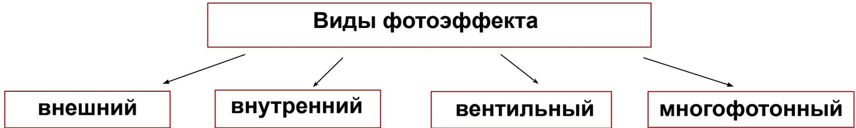
**1. Внешний фотоэффект** – явление вырывания электронов из твердых и жидких веществ под действием света.
