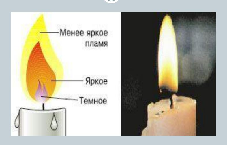
Следовательно, выводом из проведенного эксперимента может быть утверждение о том, что строение любого пламени одинаково. Практическое значение этого вывода состоит в следующем: для того чтобы нагреть в пламени какой-либо предмет, его надо вносить в самую горячую, т.е. в верхнюю, часть пламени.
