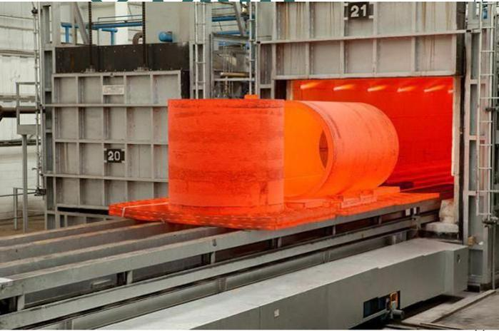
**Отжиг** – производственный процесс, при котором металлы и сплавы подвергаются нагреванию до заданного значения температуры, а затем вместе с печью, в которой происходила процедура, очень медленно естественным путём остывают. В результате отжига удаётся устранить неоднородности химического состава вещества, снять внутренне напряжение, добиться зернистой структуры и улучшить её как таковую, а также снизить твёрдость сплава для облегчения его дальнейшей переработки.
