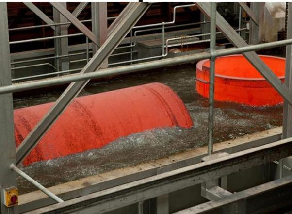
**Закалка** – это манипуляция со сплавом, целью которой является достижение мартенситного превращения металл, обеспечивающее понижение пластичности изделия и повышение его прочности. Закалка, равно как и отжиг, предполагает нагрев металла в печи выше критической температуры до температуры закалки, отличие состоит в большей скорости охлаждения, которое происходит в ванне с жидкостью
