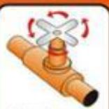
Закрой вентили (краны) на трубопроводах газа, пара, холодной и горячей воды. После отключения газоснабжающим установкам сними наружные ключи с пробковых кранов.
