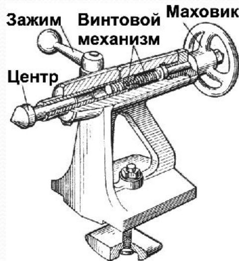
Задняя бабка (см.рис.) служит опорой правого конца длинных заготовок. Заднюю бабку подводят к заготовке по направляющим станины и закрепляют неподвижно болтом и гайкой. Окончательно конец заготовки поджимают специальной деталью — центром. Его перемещают вращением маховика и закрепляют зажимом.
