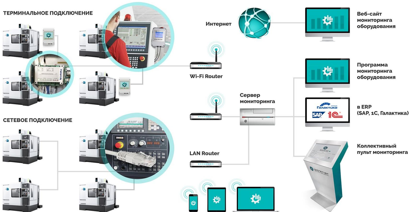
Способы подключения станков к локальной сети: сетевое, аппаратное, **комбинированное**
