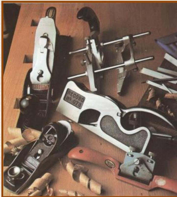
Для плоского строгания применяются основные струги – шерхебель, одинарный и двойной рубанок, фуганок и полуфуганок.
