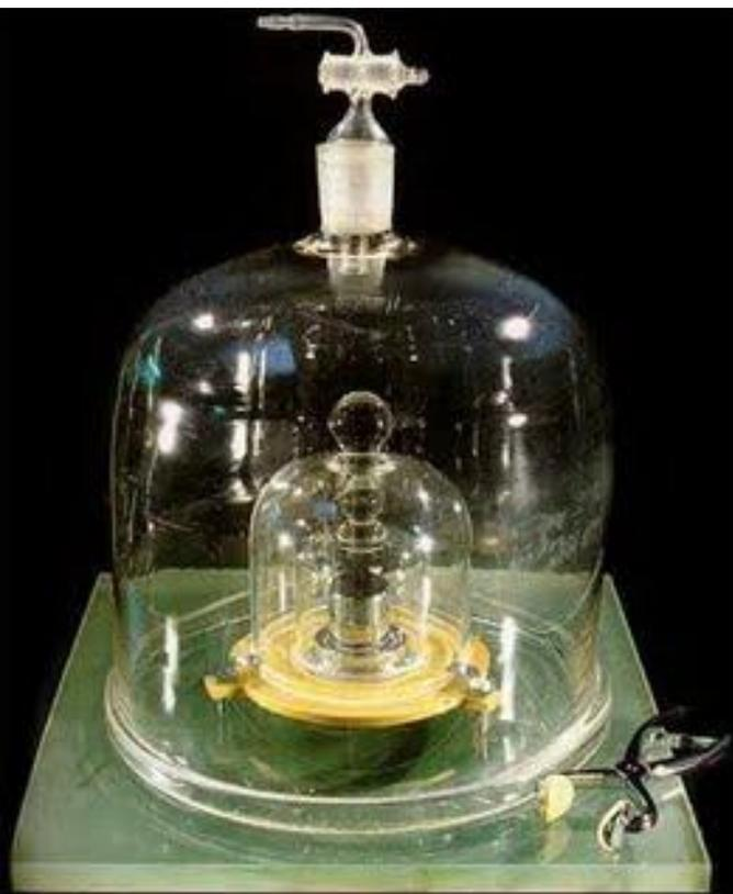
**Эталон массы изготовлен из платиново-иридиевого сплава, имеет форму цилиндра высотой примерно 39 мм. С эталона изготовлены копии: в России хранится копия №12, в США — № 20.**
