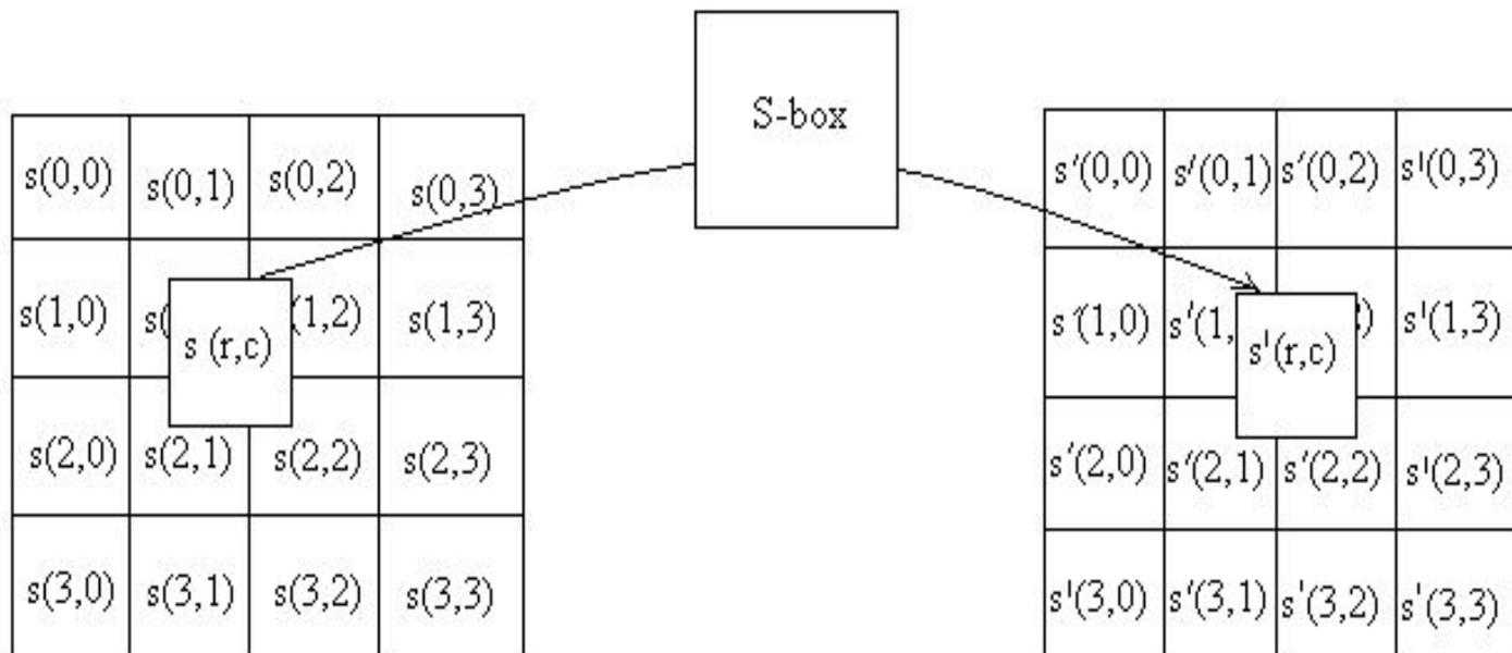
Преобразование SubBytes использует таблицу подстановок
