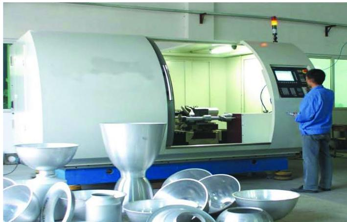
На горизонтально- давилном копировальном станке типа СДГ можно получать оболочки конической, оживальной и цилиндрической формы с длиной и диаметром до 1200 мм.
