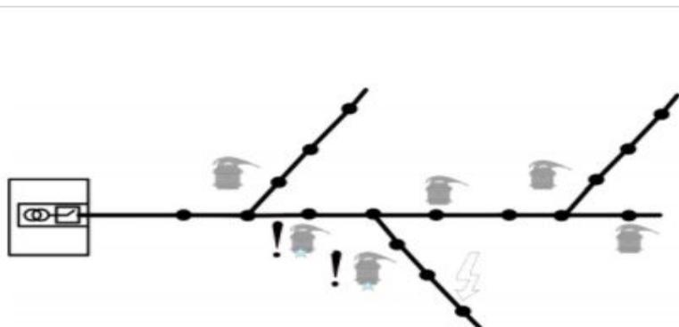
Установка индикаторов на линии с длинным стволом и длинными ответвлениями
