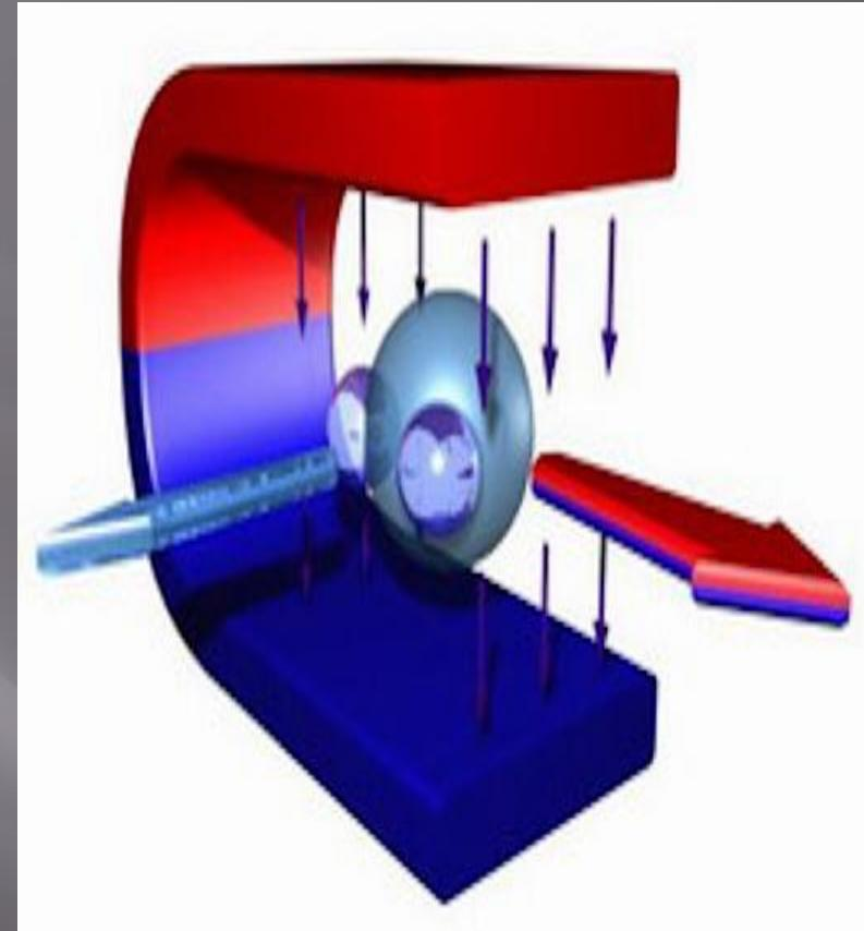
Под действием силы Лоренца изменяется направление скорости и движение заряженной частицы, но не изменяется значение скорости. Если частица движется по кругу, то радиус определяется:
