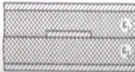
Рис. 1.11. Экранированная несимметричная полосковая линия с неоднородным диэлектрическим заполнением в виде двух слоев диэлектрика
