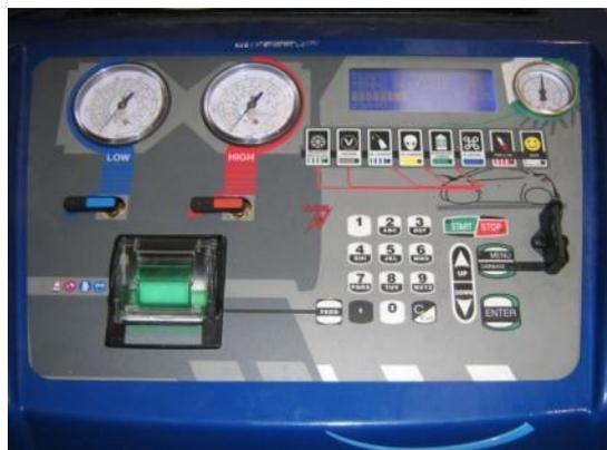
ПРИ ПОМОЩИ АВТОМАТИЧЕСКОЙ СТАНЦИИ, НАЧАТЬ ПРОЦЕДУРУ ЗАПРАВКИ И ЗАПОЛНИТЬ КОНТУР ОБЪЕМОМ УКАЗАННЫМ НА ШИЛЬДИКЕ
