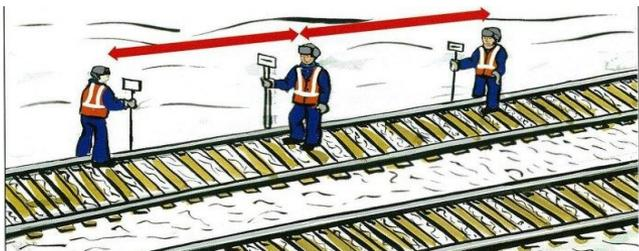
1. Определите высоту пучинного горба, длину отводов, толщину пучинных карточек
