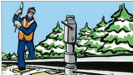
9. Опустите рельс, зашейте подкладку 2-мя костылями, не осаживая до конца. Добейте костыли на 3-й шпале сзади, наддерните на 7-й впереди и повторите цикл (рис.6-9).
